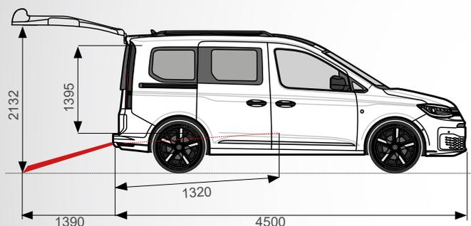
Altezza punto di ingresso 1395 mm | Altezza interna utile 1393 mm | Lunghezza tra gli ancoraggi 1265 mm | Lunghezza area stazionamento carrozzina 1320 mm | Larghezza area stazionamento carrozzina 815 mm | Lunghezza rampa aperta 1390 mm
